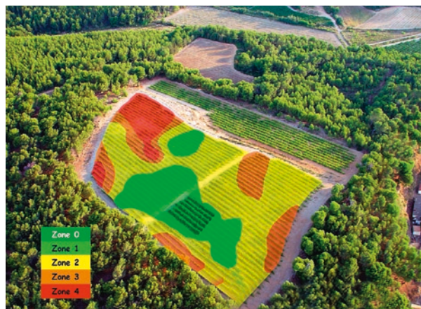
▲ Zonage intra-parcellaire d'une parcelle Syrah de l'UE de Pech Rouge située dans le massif de la Clape en fonction de l'évolution de l'état hydrique des ceps entre floraison et maturité © Inra/UEPR
