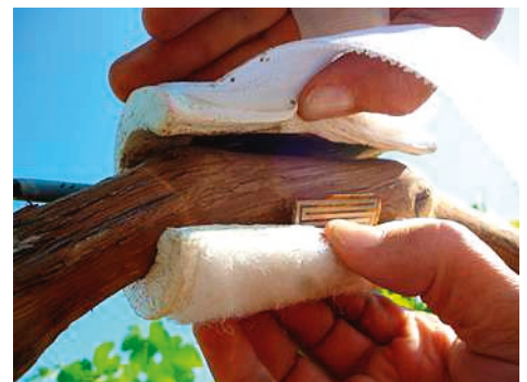
▲ Mesure du flux de transpiration d'un cep de vigne grâce à un capteur de flux de sève
